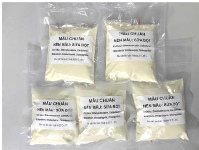
Hình 2. Hình ảnh mẫu sau công đoạn hút chân không, trước khi cho vào túi nhôm để tránh ánh sáng
